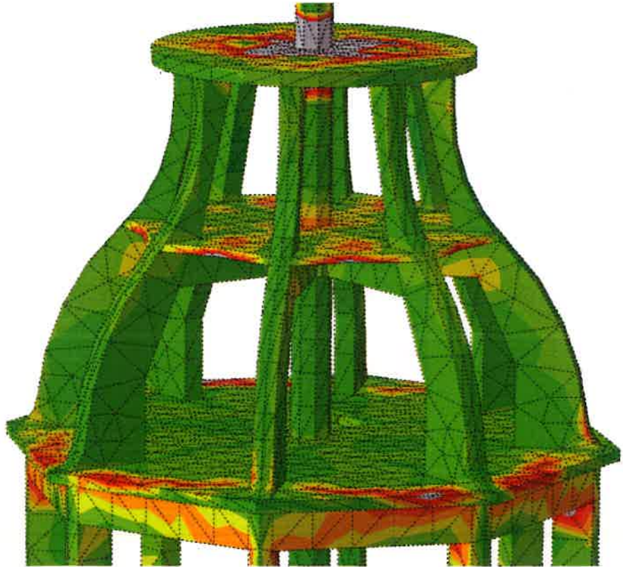
Fener Katlarındaki Kolon, Kiriş ve Döşemelerdeki Gerilme Dağılımı (N/mm 2 )
